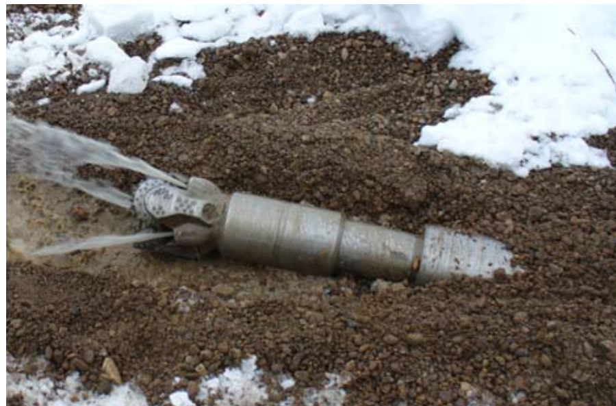
Использование полимера Magma-Fiber от компании Baker Hughes при бурении в галечнике
