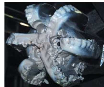
Использование присадки Terra-Rate от компании Baker Hughes (фото справа) позволило избежать налипания глины на буровом инструменте
