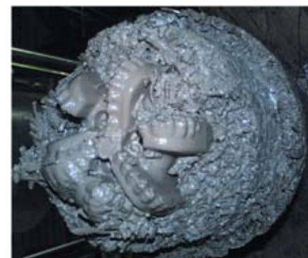
Использование присадки Terra-Rate от компании Baker Hughes (фото справа) позволило избежать налипания глины на буровом инструменте
